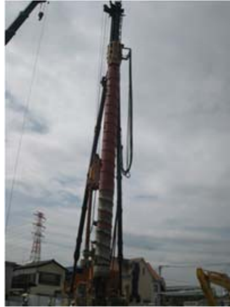
最長25mまでの掘削が可能 (リーダー30m時)
