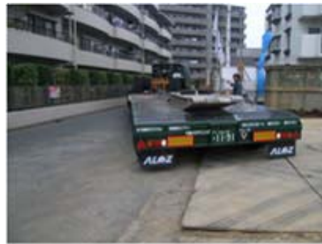
全長16m 前幅3,190mm 通常の低床トレーラーと同じ大きさ
