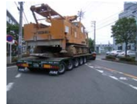
5軸すべてが独立してかじをきれる。 さらに、リモコンで強制的にもかじが きれる。
